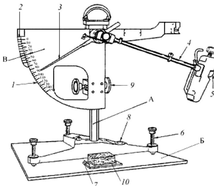
А - стойка; Б - плита-основание; В - сектор с круглыми шкалами 1 и 2; 3 - стрелка-указатель; 4 - плечо маятника; 5 - ползун с резиновым вкладышем; 6 - регулировочные винты; 7 - замки для фиксации образца; 8 - уровень; 9 - винт крепления сектора к вертикальной стойке; 10 - испытуемый образец
