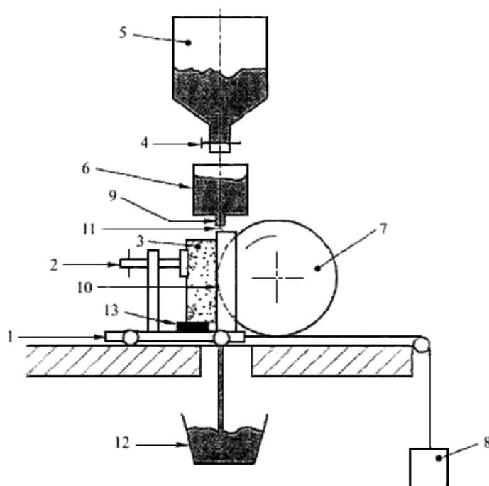
1 - тележка; 2 - винт для фиксации образца; 3 - образец камня; 4 - контрольный вентиль; 5 - бункер-накопитель; 6 - бункер-питатель; 7 - шлифовальный круг; 8 - противовес; 9 - щель для подачи шлифпорошка; 10 - канавка износа; 11 - поток шлифпорошка; 12 - накопитель шлифпорошка; 13 - клин
